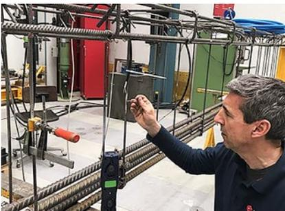
Aufkleben von Dehnmessstreifen auf Innenarmierung
