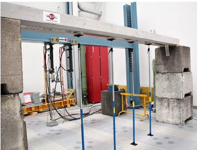
Das Tragwerkverhalten der Verstärkung wurde an Platten der Abmessungen  $L = 4 \text{ m}$ ,  $h = 150 \text{ mm}$  und  $b = 500 \text{ mm}$  geprüft. Eine Referenzplatte wurde mit zwei verstärkten Platten verglichen.
